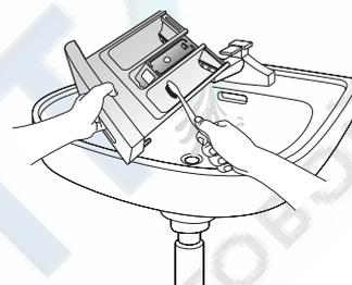
4. Очистите нишу для отсека с помощью старой зубной щетки.
