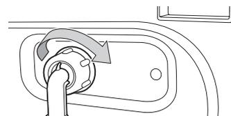
6. Включите подачу воды и убедитесь, что нет протечки воды из клапана подачи воды, крана или адаптера. Если есть протечка воды, повторите предыдущие действия.
