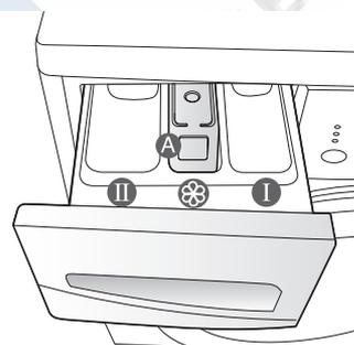
4. При использовании цикла предварительной стирки рекомендуемое количество средства для стирки следует добавить в отсек I для предварительной стирки.
