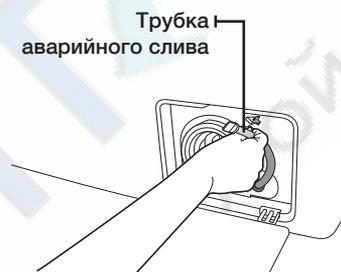
4. Снимите заглушку, закрывающую отверстие трубки аварийного слива.
