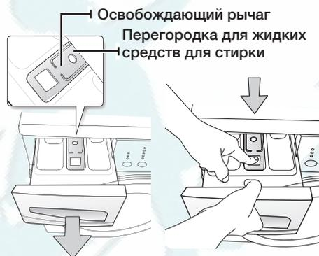
3. Промойте все части отсека проточной водой.
